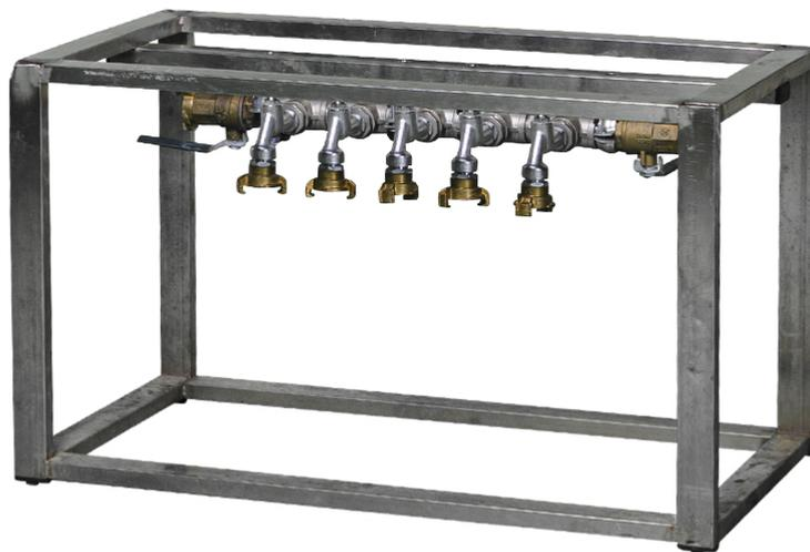
Mobiler Wasserbock mit mehreren Entnahmestellen. In diversen Größen verfügbar.
