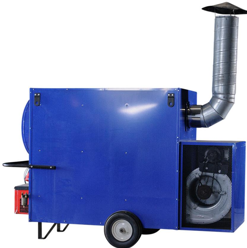
Mobile Öl-Warmluftheizung mit 200KW Heizleistung.
